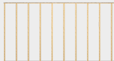
H.o.h. maat van de onderconstructie, max. 500 mm
