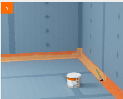
De afdichtband direct nadat hij in de folie gedrukt is, met fermacell™ vloeibare folie overschilderen
