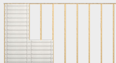
Montage van fermacell® Therm25™ vloerverwarmingselementen op de achterconstructie (schroeven 40 mm of nieten 50 mm)
